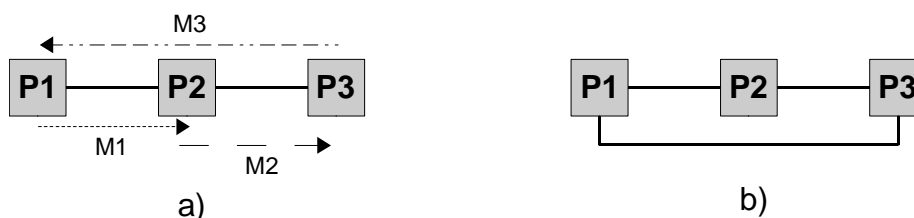
Rys. 6.2-1 Cele optymalizacji topologii NoC: liczba łącz (a), długość tras (b).
