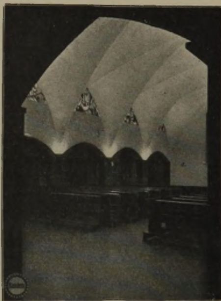
Kapelle in Attendorn. Beleuchtung mittels handelsüblicher Leuchten. Spiegelschrägstrahler in den Pfeilerköpfen untergebracht
