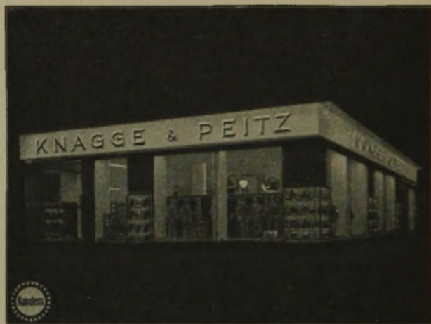
Firmenschildbeleuchtung mittels kleiner Tiefstrahler, die in der Überdachung angeordnet sind
