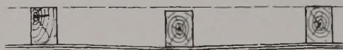
Abb. 12. Balken mit verschiedenen Querschnitten und daher ungleicher Durchbiegung ergeben Putzrisse in der Längsrichtung.
