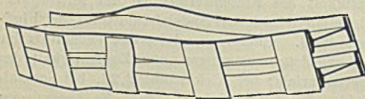
Abbildung 4. Bruchbild eines Trägerpaares Nr. 20 aus Sonderstahl.
