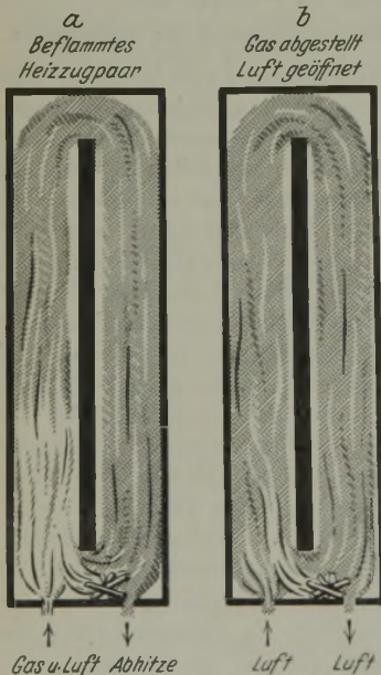
Abbildung 2. Versuche über die Wirkungsweise des Kreisstromes, kenntlich gemacht durch verschwendendes Holz.
