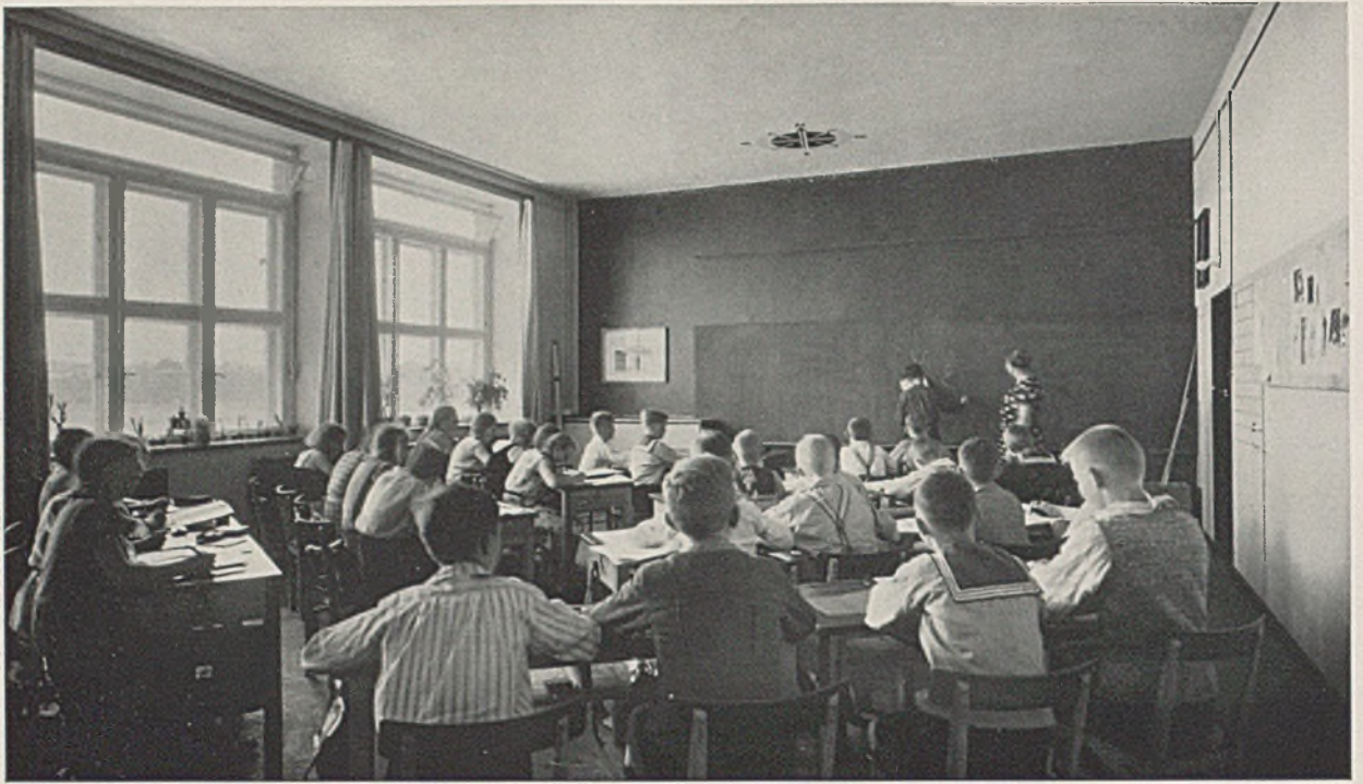
Normalklasse. Dunkle Tafelwand, rechts Sperrholz für Schülerzeichen. Gute Lüftung durch schmalen Kippflügel (läßt sich weit herunterklappen, ohne zu stören)
