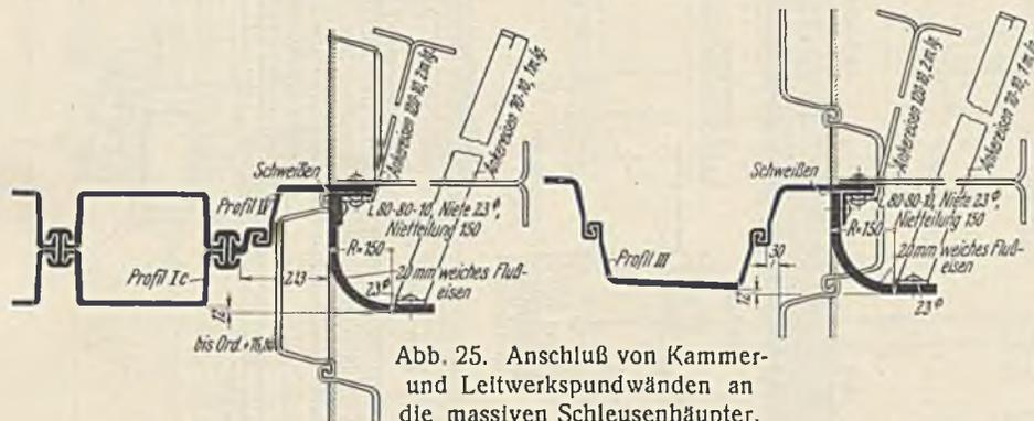
Abb. 25. Anschluß von Kammer- und Leitwerkspundwänden an die massiven Schleusenhäupter.
