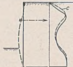
Abb. 81. Veränderung der Erddruckverteilung bei tiefliegendem Anker gegenüber der Verteilung für Bewegung C.
