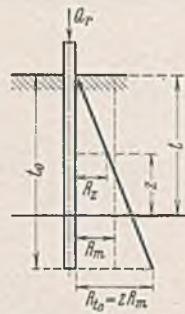
Abb. 6. Dreieckförmige Verteilung der Mantelreibung.
