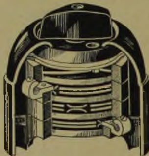
Rys. 7. Wyłącznik pakietowy (Inż. St. Ciszewski Bydgoszcz).
