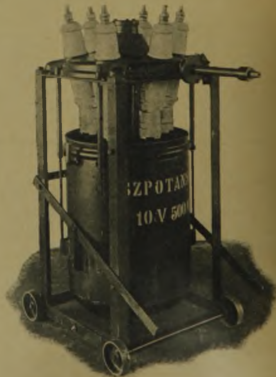
Fot. 7. Wyłącznik 500 MVA przy 6 kV.
