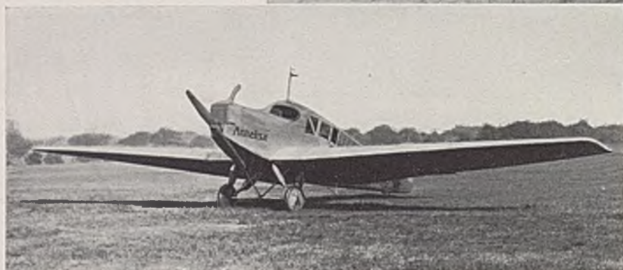
Junkers-F 13, das erste Verkehrsflugzeug der Welt in Ganzmetall und Limousinen-Bauweise, 1919.
