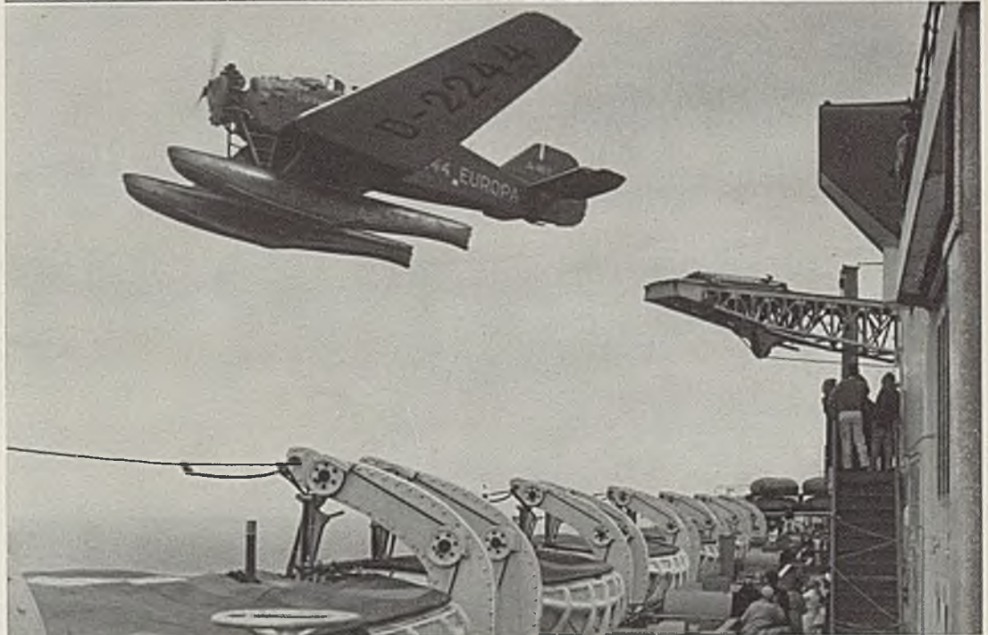
Junkers-Ju 46, katapultfähiges Postflugzeug, für Vorausbringerflüge auf den Schiffen „Europa“ und „Bremen“ eingesetzt (1932).
