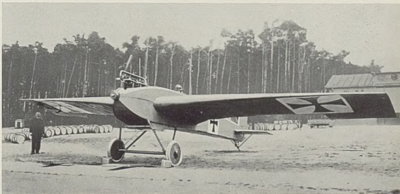
Erster freitragender Ganzmetall-Tiefdecker in Glattblechbauart, Junkers-J2, eine Weiterentwicklung der J 1, flugklar zur Front.
