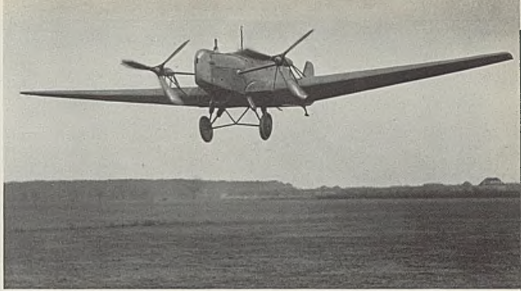
Junkers-Ju 33 mit der versuchsweisen Anbringung von Ausleger-Fernleitungsgetrieben.
