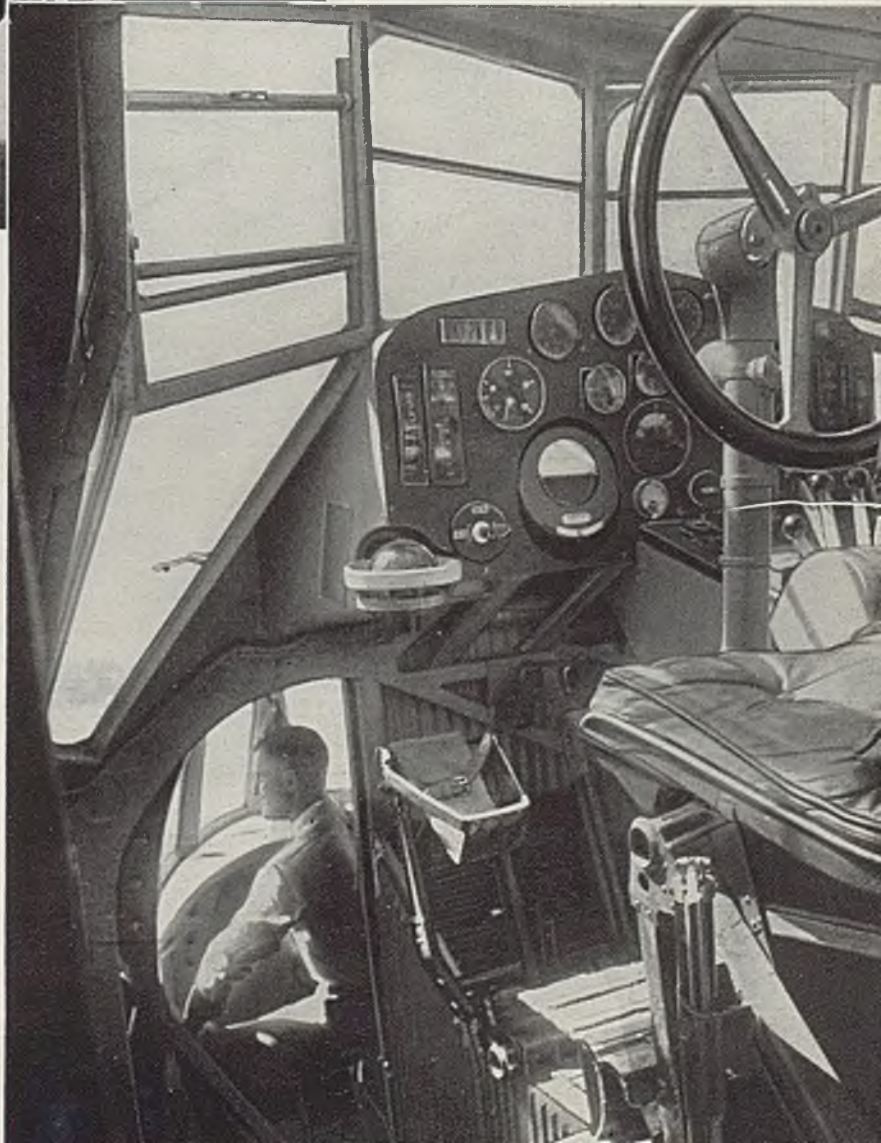
Teilansicht des Führerraumes der G 38 mit Blick in die untere Kanzel.
