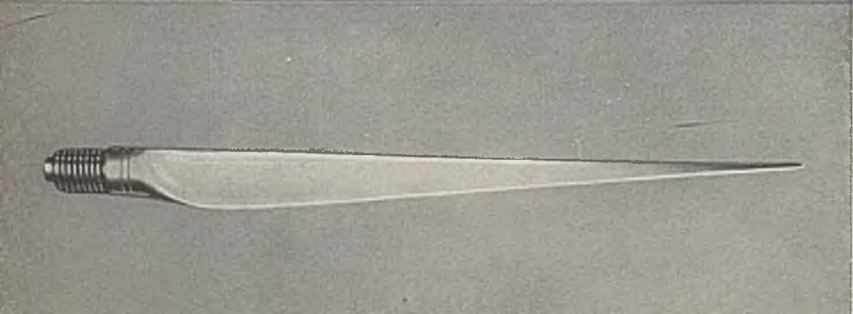
Einzelteile der Junkers-Metall-Luftschraube und nachgerichteter Luftschraubenflügel.
