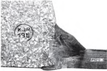
a) Makrostruktura złącza pachwinowego HR6W- Alloy 617
