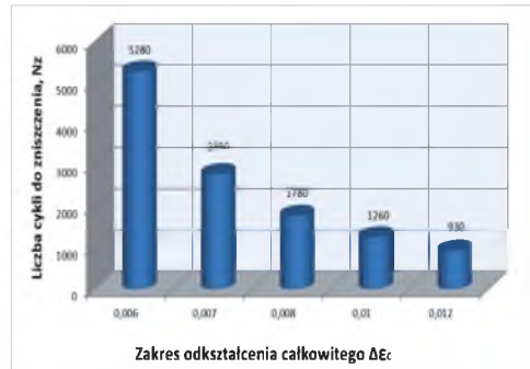
Rys. 10.5. Trwałość zmęczeniowa w zakresie całkowitego odkształcenia 0,6–1,2% stopu HR6W w temperaturze pokojowej [1]
