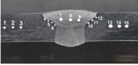
Rys. 11.18. a) Makrostruktura złącza spawanego spoiwem Thermanit 617 metodą 141, b) rozkład twardości HV10 w złączu
