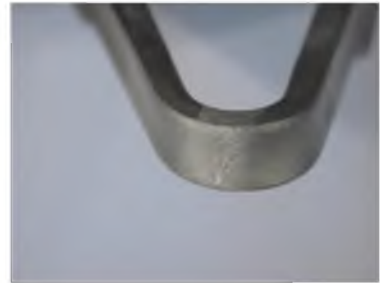
Rys. 11.19. Wyniki prób zginania złącza z rozciąganiem próbki od strony lica spoiny do kąta 90 i 180°
