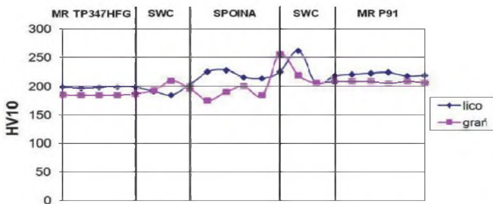
Rys. 6.18. Rozkład twardości w złączu spawanym TP347HFG-T91 po 105 000 godz. eksploatacji [3]
