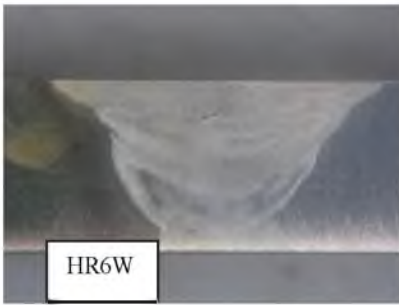
a) Makrostruktura złącza HR6W-DMV 617mod
