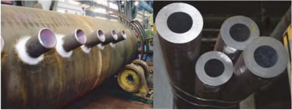
Rys. 10.32. Typowe zastosowania stopu HR6W na komory i rurociągi pary pierwotnej
