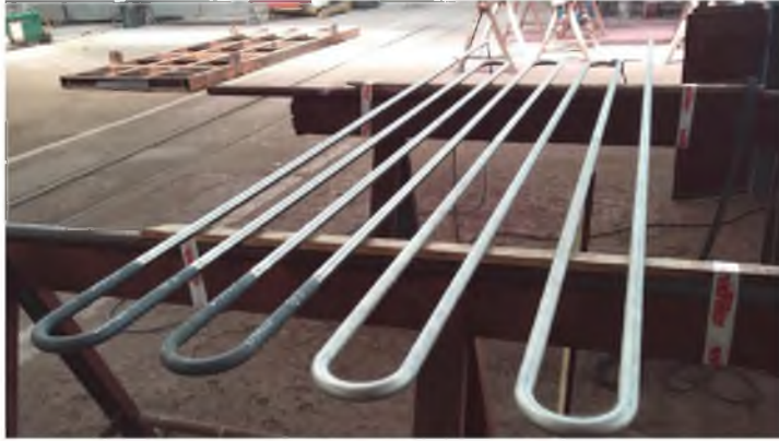
Rys. 9.31. Węzownica testowa wykonana z materiału Sanicro 25 i DMV 617mod. z lukami po gięciu oraz po przesycaaniu.
