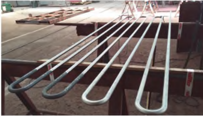
Rys. 11.30. Wężownica testowa wykonana z materiału Sanicro 25 i DMV 617 mod z lukami po gięciu oraz po przesycaaniu
