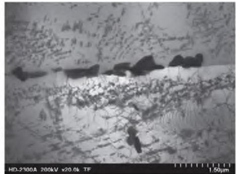
Rys. 10.23. a) Wydzielenia węglików M_{23}C_6 i fazy Lavesa na granicy ziaren austenitu po starzeniu 750°C/1000 godz., b) wydzielenia węglików M_{23}C_6 , MC i fazy Lavesa po pelzaniu 700°C/140MPa, TEM
