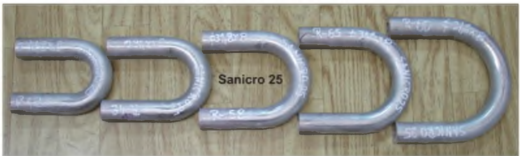
Rys. 9.27. Typoszereg wykonanych luków o promieniach gięcia 42, 48, 58, 65 oraz 80 mm
