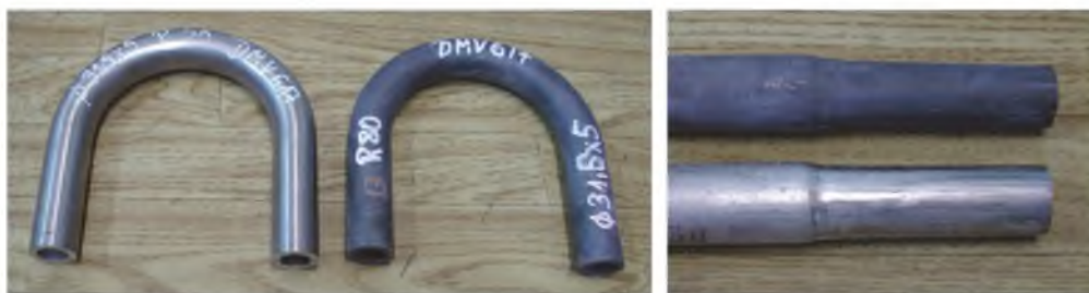
Rys. 11.23. Przykłady wykonanych luków oraz rur „butelkowanych”
