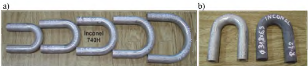
Rys. 12.27. a) Obrazy łuków po gięciu na zimno na różny promień gięcia, b) przykład łuku po gięciu i przesycaniu
