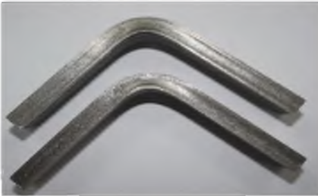
Rys. 11.19. Wyniki prób zginania złącza z rozciąganiem próbki od strony lica spoiny do kąta 90 i 180°
