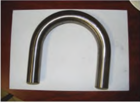
Rys. 10.28. Widok łuku ze stopu HR6W o kącie gięcia 180^\circ oraz promieniu gięcia R=100 mm
