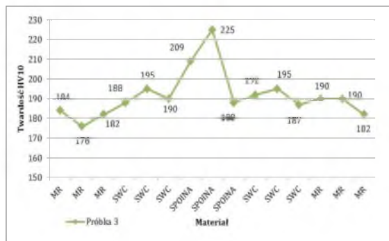
Rys. 10.18. Rozkład twardości w złączu kwalifikacyjnym wykonanym metodą 141 Aut
