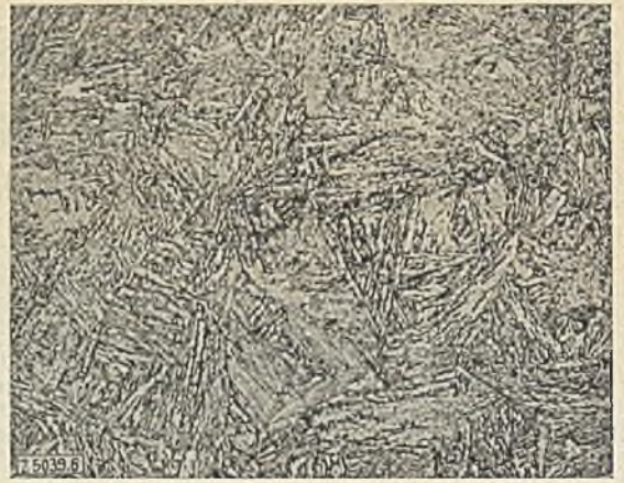
Bild 6. Gefüge der vergüteten Proben aus Stahl 2. Vergr. 500fach, Wiedergabe davon 10/20.
