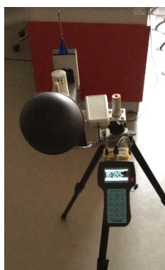
Rys.1. Miernik Mikroklimatu EHA MM101 wykorzystany do pomiarów weryfikacyjnych Fig.1. Environment Measurment Device EHA MM101 which was used for measurement results verification
