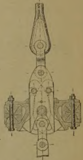
Neue verbesserte Seilauslöse-Vorrichtung. D. R.-P. 71 076.
