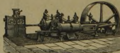
Dampfmaschinen mit einfacher, doppelter u. dreifacher Expansion nach patent. System.
