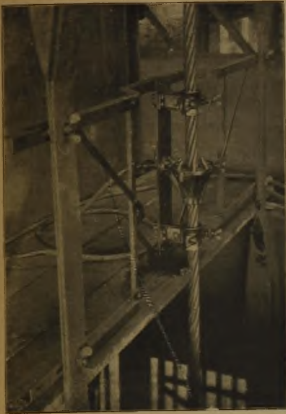
Fig. 4. Anordnung des Seilschmierapparates bei Kopf- führung des Förderkorbes.
