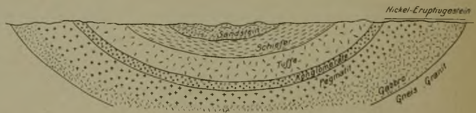
Fig. 2. Idealprofil durch das Sudbury-Nickelbecken.
