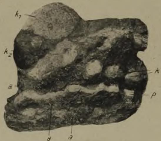
Fig. 22. Flözstück mit Torfdolomiten aus Flöz Finefrau-Nebenbank, Zeche Schnabel ins Osten. ( $1/3$  d. nat. Gr.)  $k_1$  größere Knolle mit kohligter Rinde,  $k_2$  angeätzte Brustfläche,  $k$  kleinere Knollen,  $p$  angeätzter Dolomitstreifen mit Pflanzenresten,  $a$  Glanzkohle mit zahlreichen Augen.
