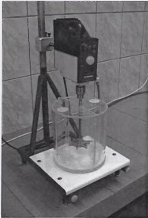
Rys. 16. Widok zestawu do badań z wykorzystaniem mieszadła turbinowego Fig. 16. A view of the laboratory set-up with the rotating impeller
