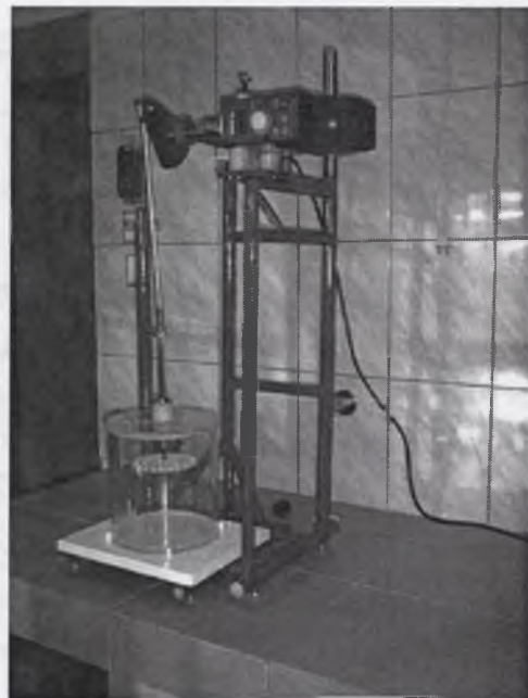
Rys. 17. Widok zestawu do badań z wykorzystaniem mieszadła wibracyjnego Fig. 17. A view of the laboratory set-up with the vibrating impeller
