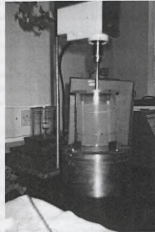
Rys. 11. Widok mieszalnika z mieszadłem obrotowym w czasie pracy: a) zawiesina kredy w wodzie na początku agregacji; b) zawiesina kredy w wodzie po osiągnięciu stanu równowagi dynamicznej
