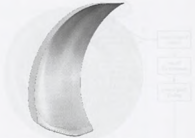
Rys. 7.36. Widok łopatki przestrzennej, po połączeniu przekrojów Fig. 7.36. The view of a space blade after joining cross sections
