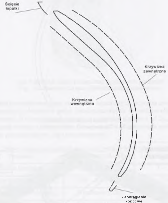
Rys. 7.33. Podział łopatki wirnika na obiekty elementarne Fig. 7.33. The partition of a blade on features
