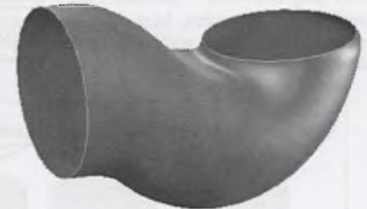
Rys. 7.19. Element uzyskany metodą rozpinania powierzchni Fig. 7.19. The element obtained using the method of surface tacking
