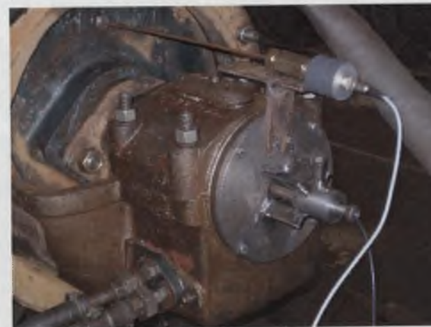
Rys. 9.9a. Widok pompy od strony tłocznej, z czujnikiem do pomiaru ciśnienia p_2 przed tarczą odciążającą i wiroprowadowym czujnikiem położenia osiowego wału Fig. 9.9a. View of the pump seen from the pressing side, with a sensor for measuring the pressure under the balance disk and a whirling sensor of position, controlling the axial position of the shaft
