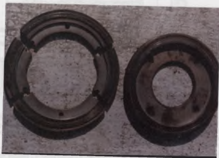
Rys. 1.4. Pierścienie tarczy odciążającej po awarii spowodowanej błędem rozruchowym [42] Fig. 1.4. Balance disk rings after a failure due to incorrect starting [42]
