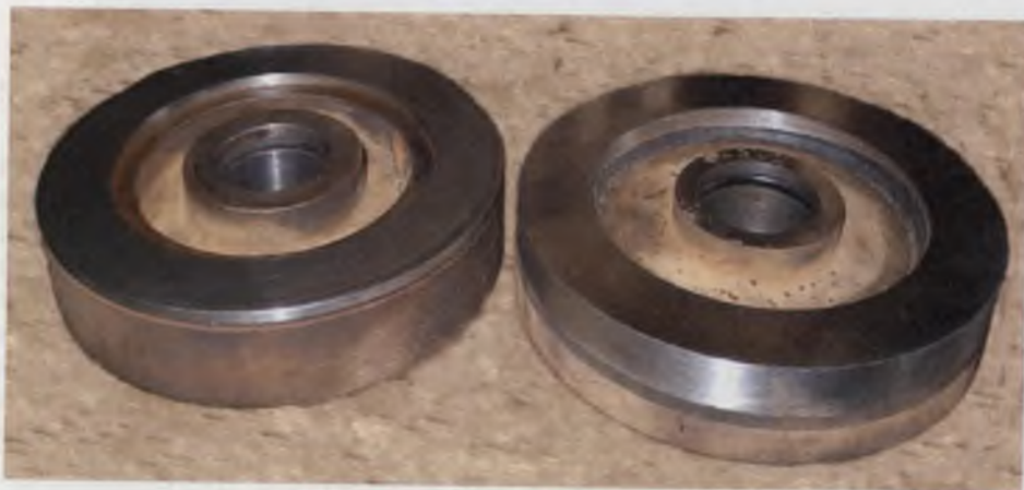
Rys. 4.10. Widok badanych tarcz B i A: z pierścieniem „pływającym” i z pierścieniem wulkanizowanym Fig. 4.10. View of the investigated discs B and A: with a "floating" and a vulcanized ring
