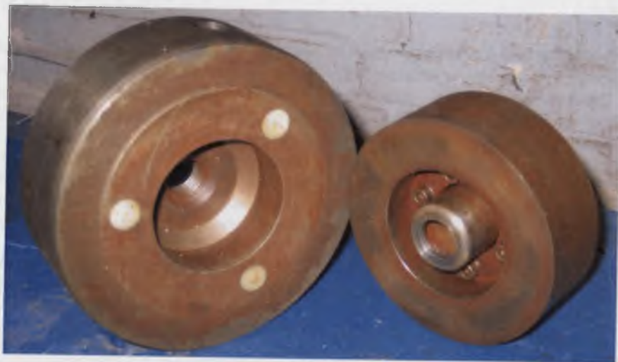
Rys. 4.7. Pierścień oporowy 2 z trzema wstawkami do osłony czujników wiropędowych i tarcza 3 stanowiąca monolit z pierścieniem ślizgowym, osadzona na elemencie sprężystym 1 Fig. 4.7. Thrust ring 2 with three inserts screening the off-position sensors and disk 3 constituting a monolith with a slip-ring, mounted on the elastic element 1
