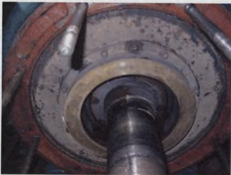
Rys. 9.22. Podatny pierścień oporowy po kolejnym okresie pracy Fig. 9.22. Flexible thrust ring after a successive period of exploitation
