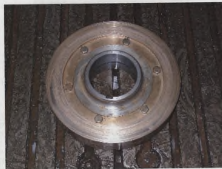
Rys. 9.11. Tarcza z pierścieniem ślizgowym z otarciami spowodowanymi dyfuzorowością szczeliny Fig. 9.11. Disk with a slip-ring abraded due to the diffusivity of the clearance
