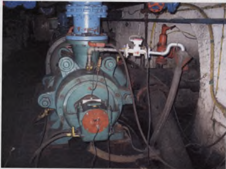
Rys. 9.17. Pompa OW-250/4 na stanowisku pracy w KWK Kazimierz – Juliusz z dodatkowym oprzyrządowaniem do pomiarów kontrolnych
