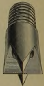
Fig. 26. Schlagmeißel für das Zertrümmern von Kiesel usw.
