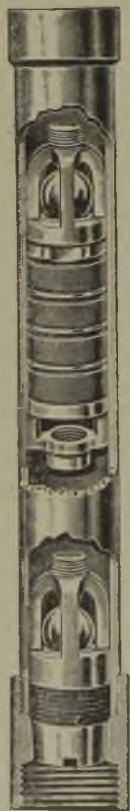
Fig. 31. Bohrlochpumpe mit Kugelventilen.
