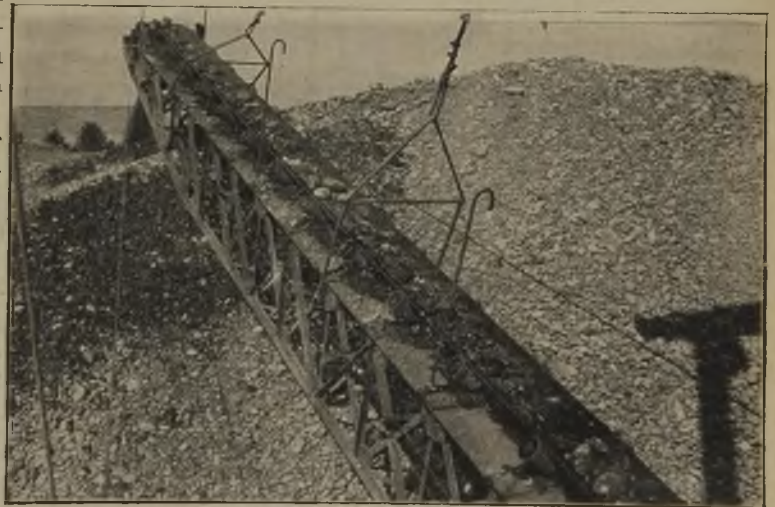
Fig. 40. Aufhaltung des verarbeiteten Gebirges mittels Gurtförderer beim Goldbaggern.
