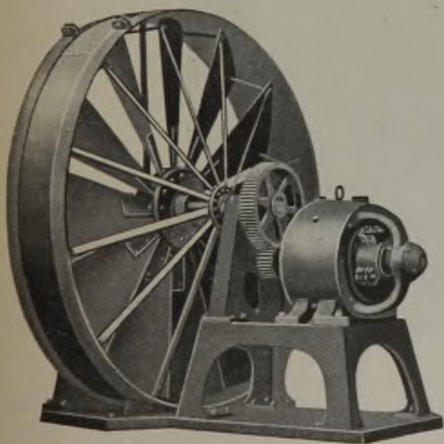
Fig. 109. Schraubenventilator mit elektrischem Antrieb. S. B. Stine and Son, Osceola Mills, Pa.
