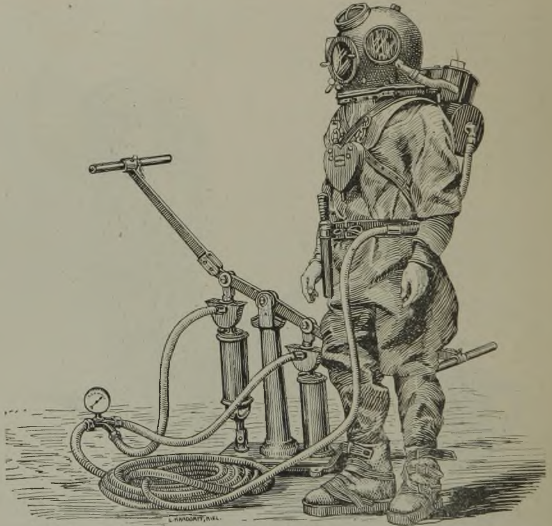
Fig. 2. Taucher nach französischem System mit Luftregulator.
