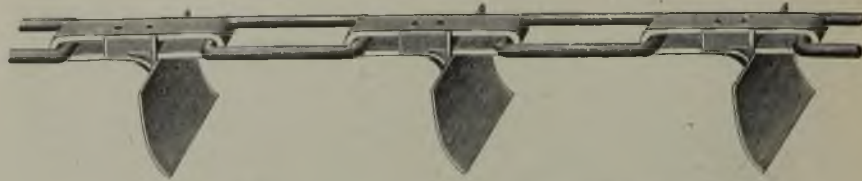
Fig. 121. Kratzerförderer mit Kette und rechteckigen Blättern.
