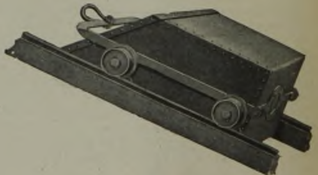
Fig. 100. Skip auf der Förderbahn. Fraser und Chalmers, Chicago.
