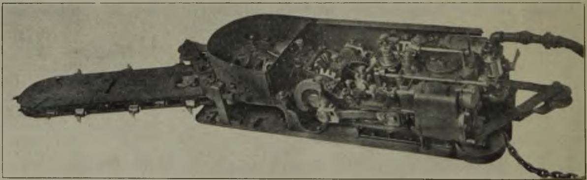
Fig. 2. Sullivan-Schrämmmaschine mit abgenommenem Schutzdeckel.
