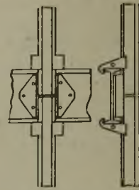
Fig. 4. Vorder- und Seitenansicht der Führungsschienenbefestigung.
