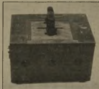
Fig. 4. Leistungsmesser-Umschalter für 400 A, 6000 V in geschlossenem Schutzkasten.
