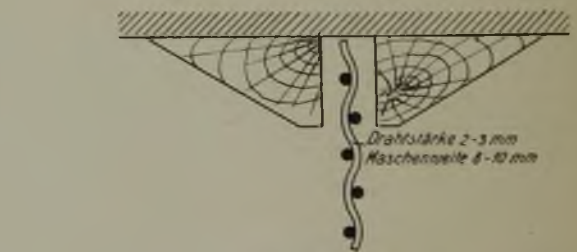
Fig. 3. Führung der Beruhigungs-Drahtsiebe.
