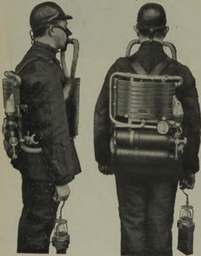
Fig. 5. Rückenansicht des gebrauchsfertigen Westfalia-Apparats, Type 1908, für Mundatmung.
