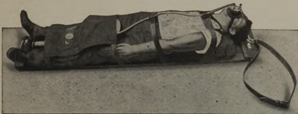
Fig. 6. Schleifbrett „Westfalia“ mit Wiederbelebungsapparat.
