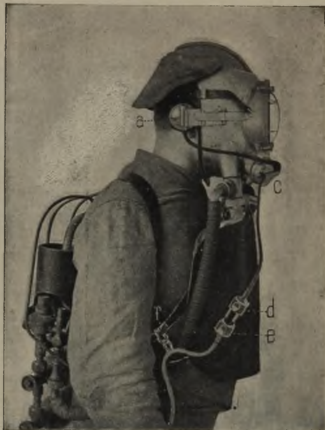
Fig. 2. Rauchhelm des Drägerwerks mit Fernsprecheinrichtung.
