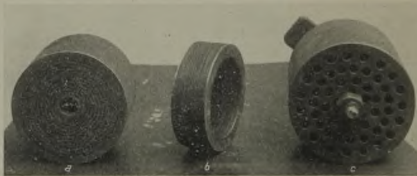
Fig. 3. Schutzvorrichtungen für die Luftansauge- und Auspuffleitung.
