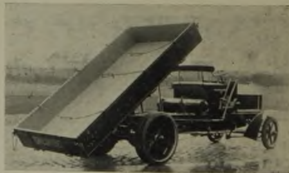
Fig. 3. Daimler-Kippwagen mit Zahnstangenantrieb.
