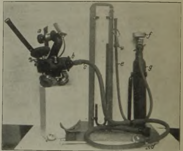
Abb. 3. Einrichtung zum Prüfen und Vorfüllen mit Sauerstoff.
