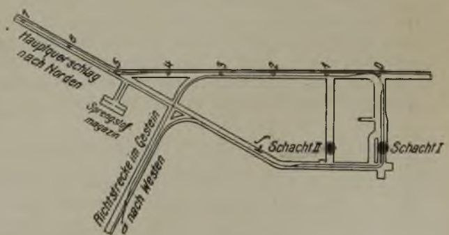
Abb. 24. Grundriß der Füllörter und Umbrüche.
