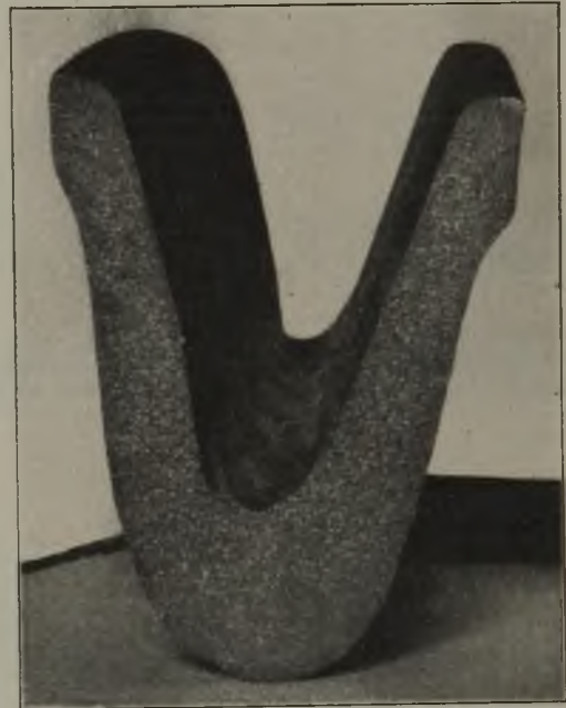
Abb. 1. Ansicht und Querschnitt einer durch das Seil ausgefrästen Seilscheibe.
