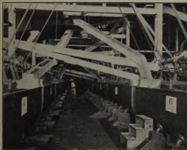
Abb. 6. Setzmaschine für Mittelkorn (rechts) und für Feinkorn (links).
