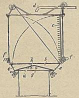
wässerung des Gutes vermittelst einer in g angeschlossenen Saugpumpe. Der trockene Schlamm wird durch e abgezogen. Vermittelst der eggenartigen Vorrichtung c wird nach Aufhebung des Siebes b die das Kohlenklein bedeckende filzige Thouschicht durchlöchert. h ist ein Wasserzusserbricht zum Zwecke der Reinigung des Siebes oder erforderlichenfalls zur nochmaligen Durchwaschung des Kohlenkleins.
