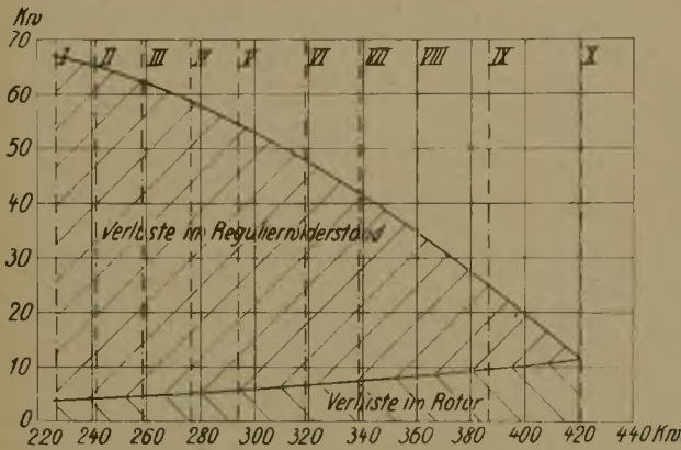
Fig. 11. Leistungsverlust im Regulierwiderstand.
