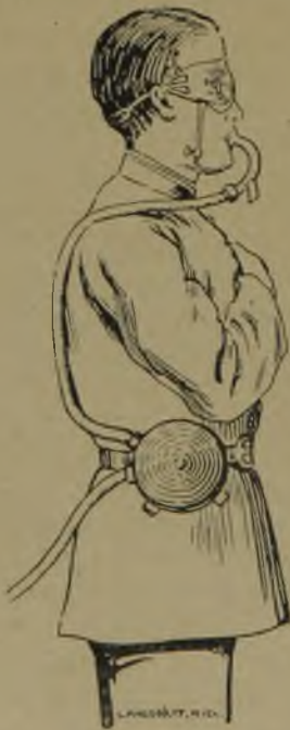
Fig. 69. Atmungsapparat „Simplex“ von L. von Bremen.
