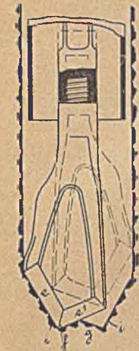
5a. 13 585, vom 1. Juni 03. August Dettmer in Genck (Belgien). *Vorrichtung zur Vergrößerung des Bohrgestängehubes bei gleichbleibendem Schwengelhub.*
