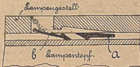
der Lampe in die Nut des Lampentopfes gedrückt bzw. schleift über die untere Klinke a hinweg. Das Öffnen der Lampe kann dann nur mittels eines von oben her angreifenden Magneten
