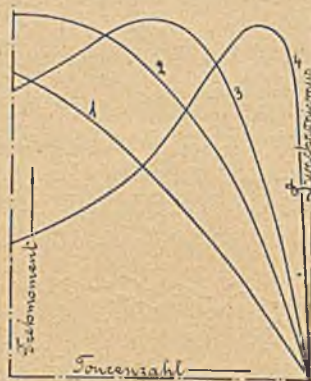
Fig. 9. Drehmomentumlauf eines Drehstrommotors für verschiedene Ankerwiderstände.
