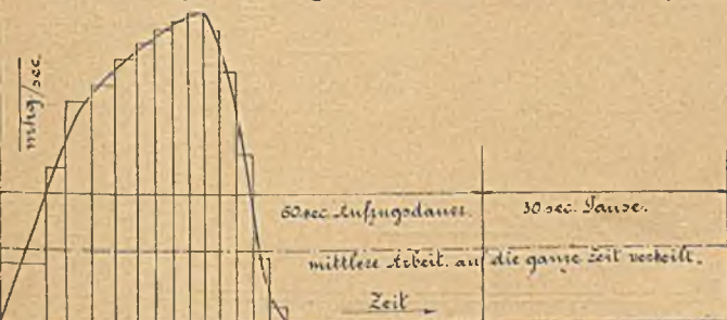
Fig. 15. Arbeitsdiagramme einer Compoundfördermaschine für 3750 kg Nutzlast und 450 m Teufe.
