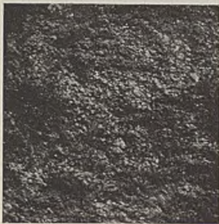
Fig. 4. Rheinisch-westfälischer Koks aus ungestampfter Kohle. 9,5 pCt Asche, 1,276 pCt Schwefel, 1,02 pCt fl. Bestandteile.
