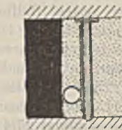
Fig. 3. Anfüllung des Raumes zwischen Stempeln und Kohlenstoß mit Spülversatz.
