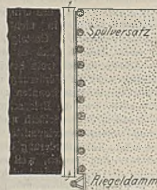
Fig. 1. Einbau von Wetterlütten zwischen Kohlenstoß und abgebauter Fläche.
