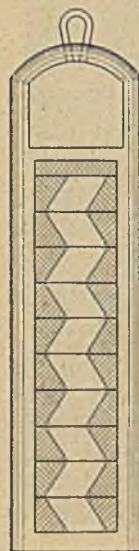
Fig. 2. Längsschnitt durch die heizbare Koksofentür.
