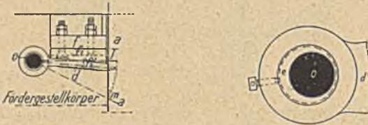
Fig. 8. Keilregulierung. Fig. 9. Exzenterfutterregulierung.
