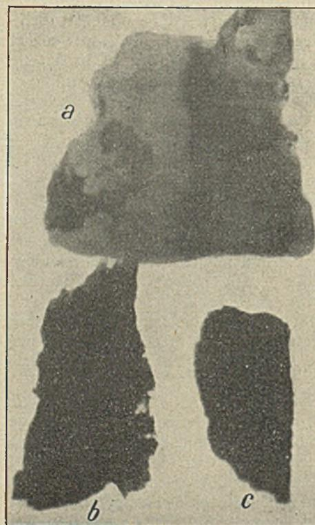
Abb. 3. Röntgenbilder von Kohlenstückchen mit erheblicher Mineralbeimengung.
