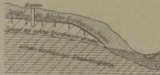
Abb. 3. Darstellung eines falschen und eines echten Grundwasserstromes.
