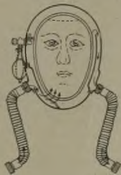
Abb. 8. Schematische Darstellung der Helmabdichtung.
