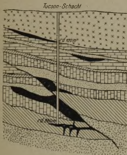
Abb. 2. Profil durch den Förderschacht der Tucson-Grube bei Leadville.
