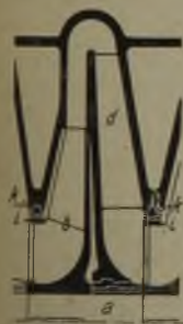
Abb. 16. Schnitt durch den Kreisel-Gassauger, Bauart Brown, Boveri & Co.
