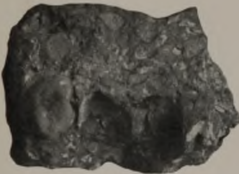
Abb. 3. Zechsteinkonglomerat. Das große Geröll (links) liegt in der Ebene der Schichtung. \frac{1}{7} natürlicher Größe.
