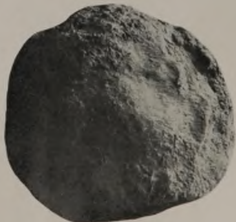
Abb. 6. Kohlenkalkgeröll mit gut ausgeprägtem Harnisch. \frac{1}{6} natürlicher Größe.
