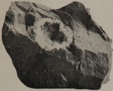
Abb. 1. Weicher Kalk des untern Zechsteins mit Kalkspatdruse. \frac{2}{3} natürlicher Größe.
