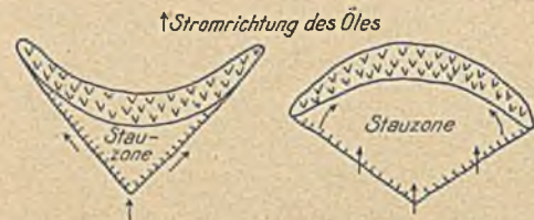
Abb. 11. Bildung einer Öl-Stauzone vor der konkaven oder konvexen Seite eines Saliferaufbruches (nach Kraus).
